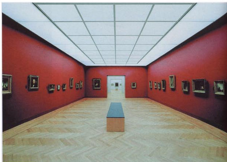
Zwei Beleuchtungsarten wurden im Georg-Schäfer-Museum Schweinfurt (Entwurf: Volker Staab) kombiniert: in der Mitte Tageslichtfelder, am Rand Licht aus Leuchtstoffröhren.
